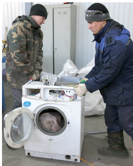
■ Рабочие разбирают стиральную машину - пластик отдельно, металл отдельно.
